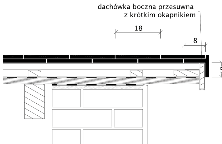
Rysunek techniczny produktu AMBIENTE KRÓJ PROSTY - przekrój poprzeczny połaci dachu
