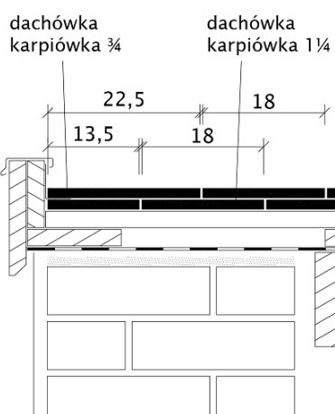
Rysunek techniczny produktu PROFIL SÄCHSISCHE BIBER 18X38X1,4 - przekrój poprzeczny połaci dachu
